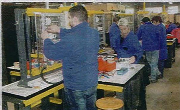
■ Des élèves effectuant des opérations de câblage sur des armoires électriques au sein de l'atelier d'électrotechnique.
